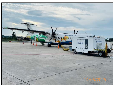
ภาพถ่ายที่ 2-18 การใช้เครื่องกำเนิดไฟฟ้าเคลื่อนที่เมื่อลงจอด
