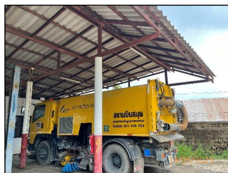
ภาพถ่ายที่ 2-3 รถดูดฝุ่นที่ใช้ทำความสะอาดทางวิ่ง-ทางขับ
